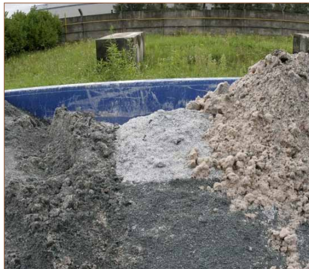
Déchets minéraux (paillettes d'ardoise et déchets de démolition) recyclés pour réutilisation dans les remblais de routes
